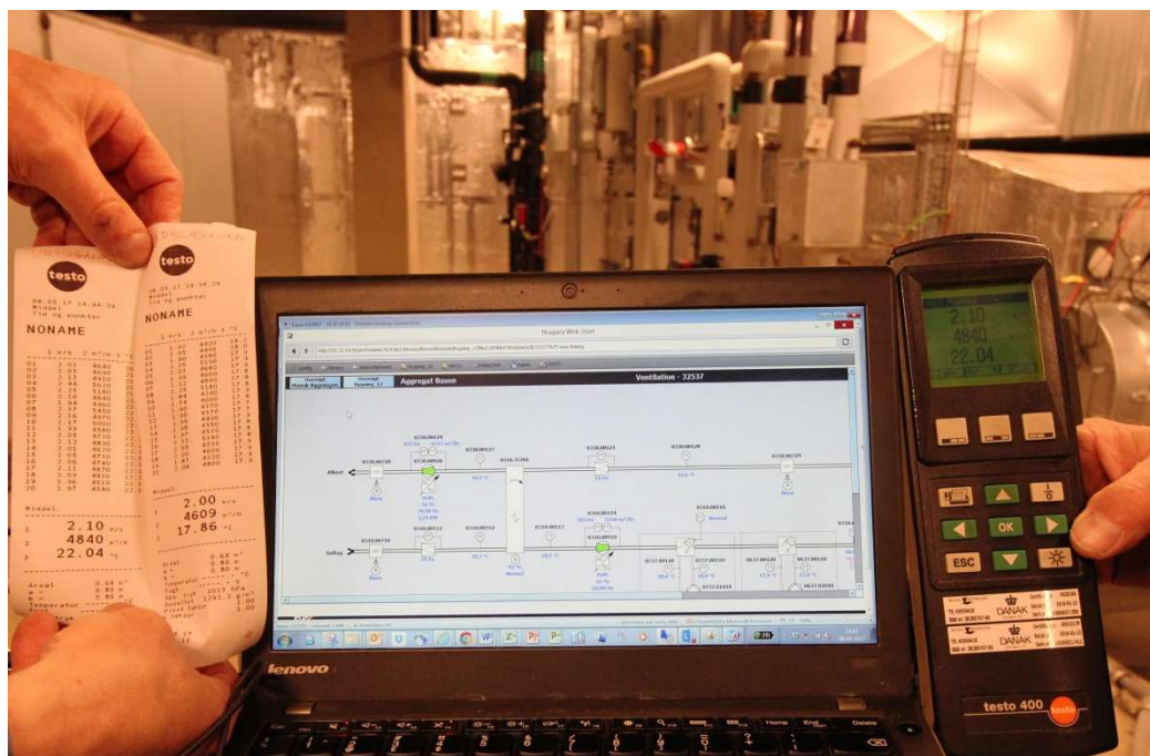
Illustration nr. 3 herover og 4 herunder. Foto fra igangvære performancetest, hvor der udføres stikprøvekontrol mht sammenhæng mellem anlægsopbygning, anlægsbillede, instrumentering, følernøjagtighed og logninger.
